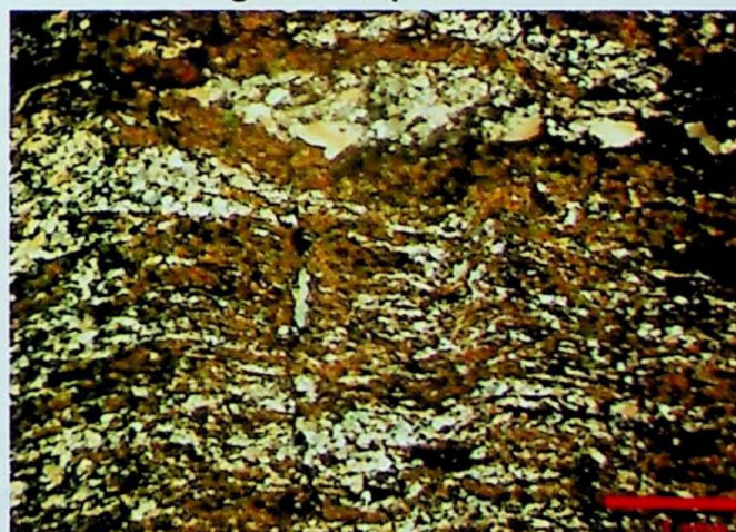
Fotomicrografia 9 – JB-VI-03. Nicóis cruzados. Quartzo com contatos serrilhados a lobados.
