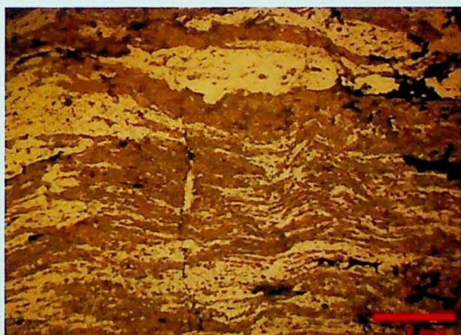
Fotomicrografia 8 – JB-VI-03. Nicóis paralelos. S2 crenulada com minerais opacos associados.
